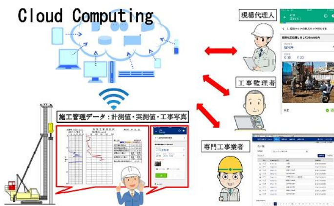
図-1 既製コンクリート杭施工データ総合管理システム「T-Pile Recorder」の概念図
