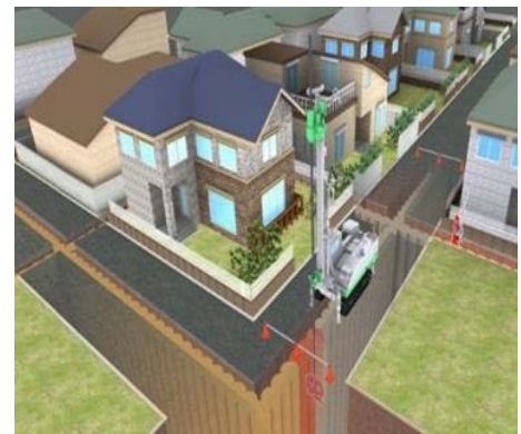
図-1 宅地と道路一体の液状化対策
