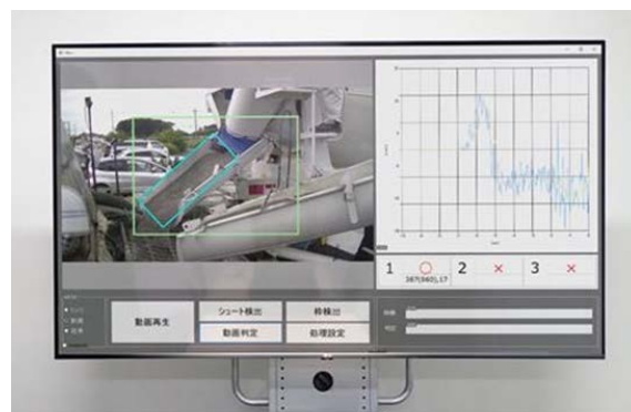
写真-1 動画画像分析を活用した コンクリート性状判定画面
