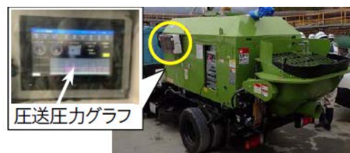
写真-1 自動打込み・締固め装置、ポンプ制御
