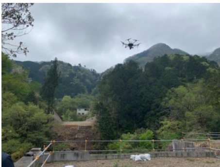
写真3 UAV 3次元レーザースキャナ測量
