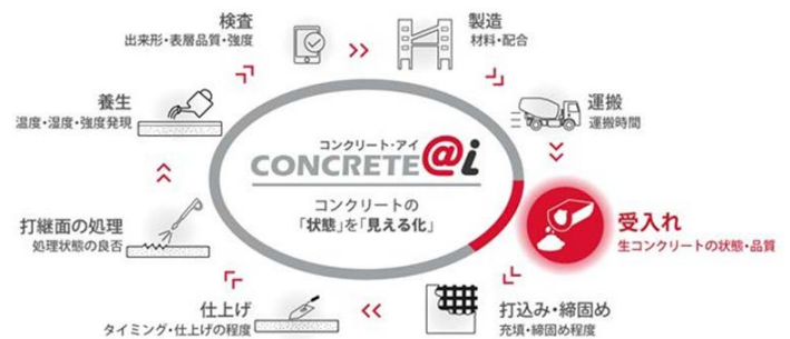
図-3 コンクリートの状態の「見える化」 ～コンクリート・アイ～
