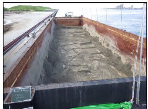
【船倉内に残った土砂の状態】
