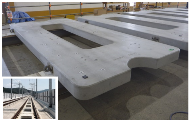
写真 2 鉄道構造物の軌道スラブ
