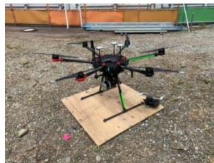
写真3 UAV 3次元レーザースキャナ測量
