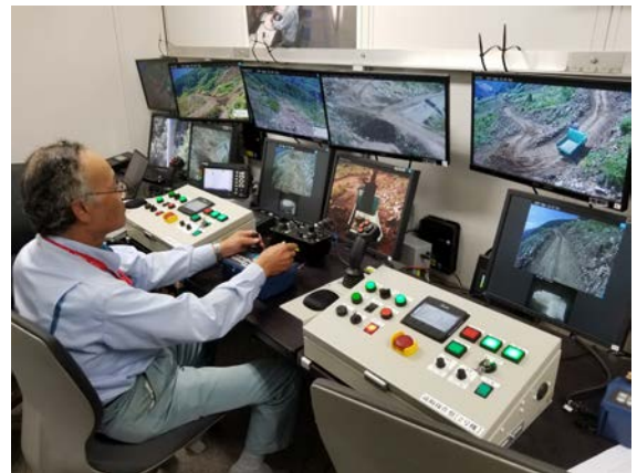
実施工状況(遠隔操作室)
