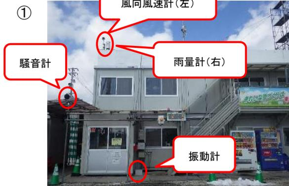
②事務所に、騒音計・振動計・雨量計・風向風速計を設置している。作業中、数値の見える化により日々安全対策に努めている。
