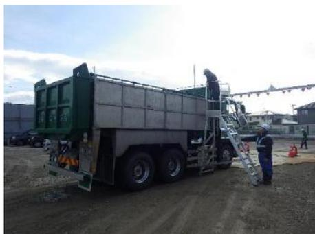
②ダンプトラック等荷台への可搬式昇降設備を用い負担軽減及び転落防止対策。
