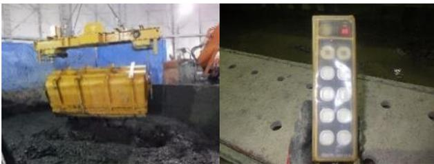
従来、鋼車からずりを排出する際は玉掛け作業が発生した。当現場では、自動転倒式を採用し、無線制御機のボタン一つで鋼車を回転させてずりを自動排出できる。そのため、作業効率と安全効果が向上した。
