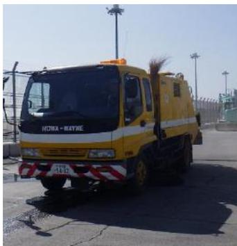
当作業所では、散水車で適宜散水し、粉じんの影響防止に努めている。また、定期的に場内をロードスイーパーで清掃し、粉塵の堆積予防を図っている。
