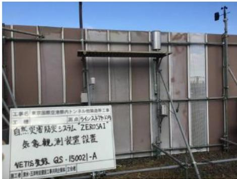
雨量計、風力計、風向計、温度計、湿度計で構成されるこの装置のデータは、パソコン上で閲覧可能。ピンポイントの予報が得られるため、安全管理や作業内容の変更役に役立っている。
