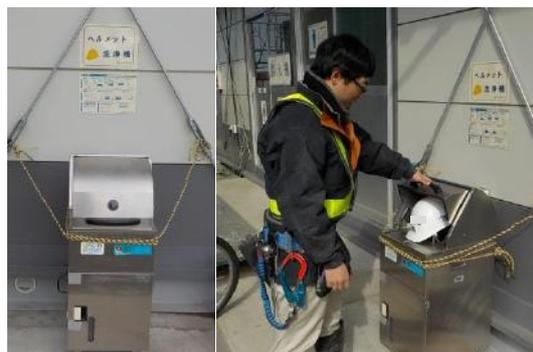
ヘルメット洗浄機を詰所入口に設置し、衛生保持に努めている。この装置は、ヘルメットの内部を除菌・消臭可能で、作業終了時には多くの作業員に利用してもらっている。
