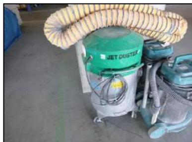
粉塵が発生する作業では、集塵機を使用して、粉塵の拡散を防止。
