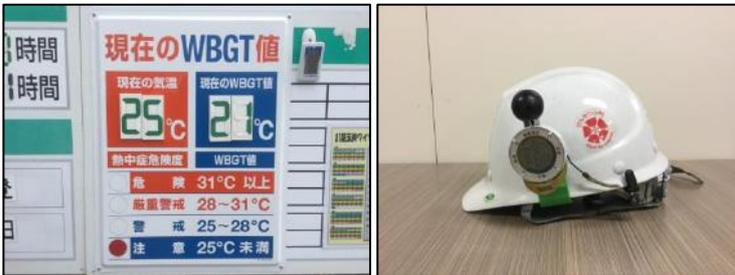
・安全掲示板に WBGT モニターを設置し計測と表示を実施。担当職員等がヘルメットに黒球付温湿度計を付けて現場各所で実測し、実状に合った注意喚起を実施。
