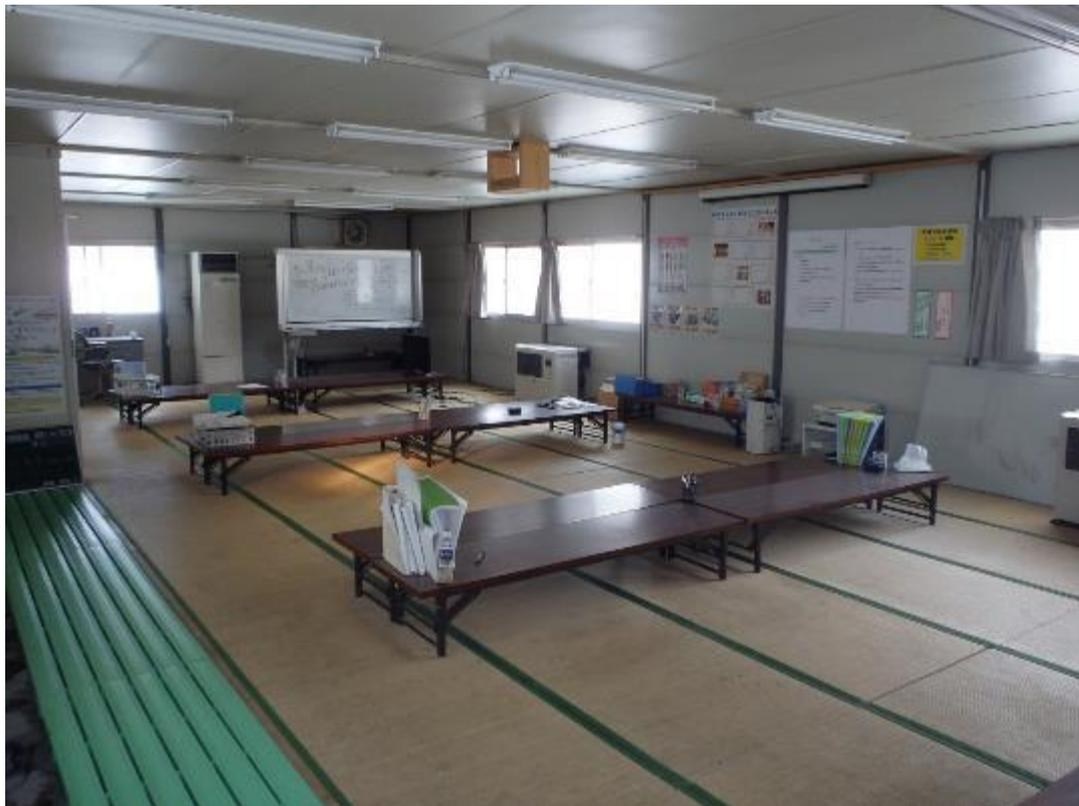
冷暖房付きの現場詰所。冷房2台、暖房2台を設置し、常時 22℃から 26℃適温を保つことで冬は-20℃から夏は 30℃以上になる外気温をしのげるようにしている。
