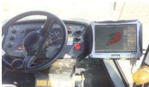
トンネル掘削ずり約70万m<sup>3</sup>の盛土管理にGNSSによる盛土管理を採用し、モニターに映し出される転圧回数の色で管理することで、視覚的に分かりやすくし、オペレーターの負担を軽減した。
