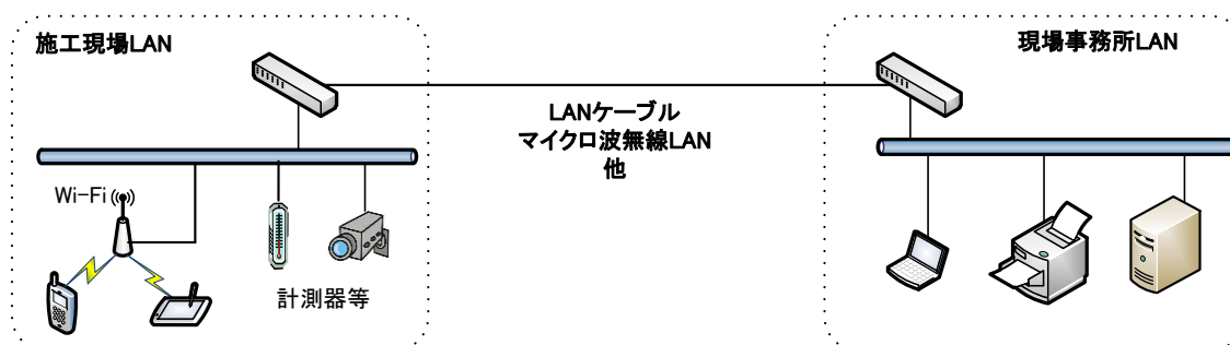
図 2-3 ケーブルの延長による接続
