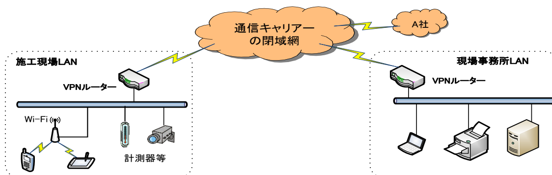
図 2-4 通信キャリアの VPN サービスを使った接続
