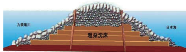
図 2.1.19 エッセル堤の断面推定図 8)
