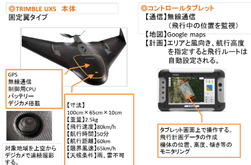
図－1 UAV 機器の詳細
