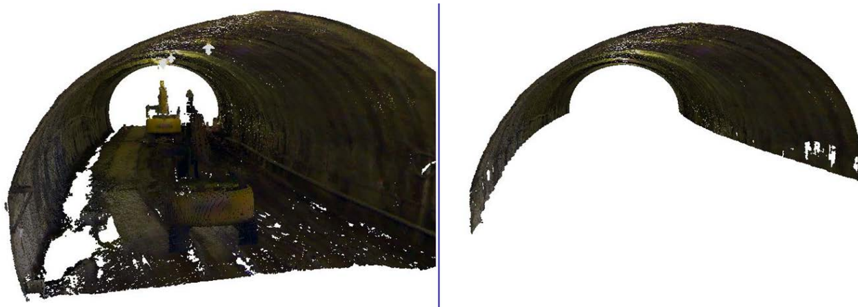
3Dレーザースキャナによる出来形計測（点群データのノイズ処理）
