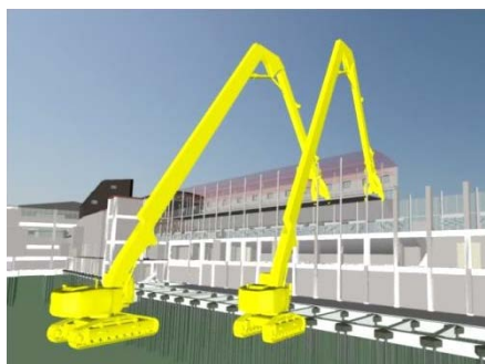
図4 重機配置検討図
