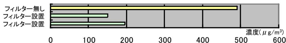
図2 空調機吸着材フィルターの効果(室内TVOC濃度の比)
