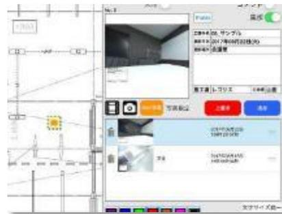
360° 写真はSPIDERPLUSに登録後、一部分を長方形に切り抜き、一般的な写真データとしても利用。
