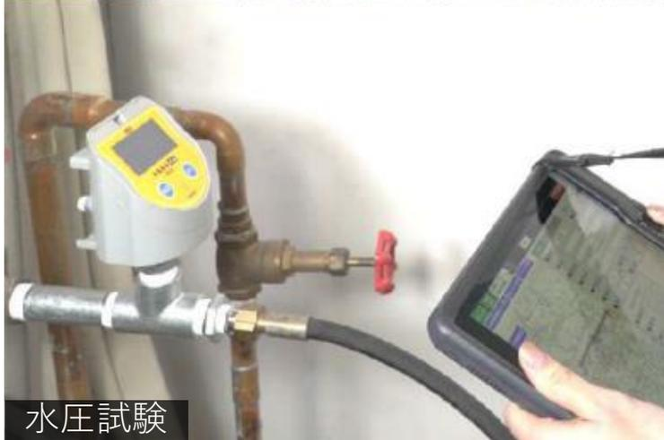
冷媒気密試験が行えるレッキス工業圧力試験器Ⅲ TKR12P
