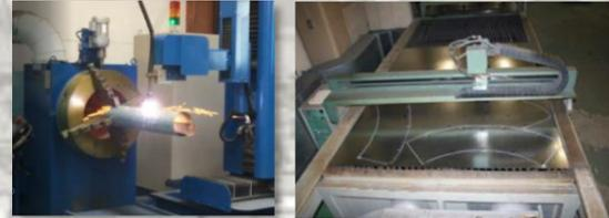
施工図として作成したBIMモデルおよびその情報を配管やダクト、その他の製作モノの加工にデータ活用
