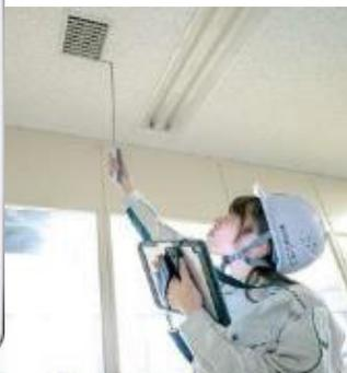
計測したデータはリアルタイムに表示。検査結果をその場で確認することができる。
