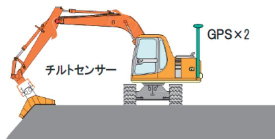
図-5 端部法面締固めイメージ
