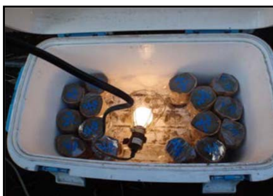
写真-6.2 クーラーボックス内に熱源を入れた初期養生の状況
