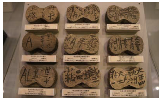
写真 2.1.5 百年耐久性試験 供試体
