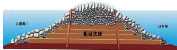
図 2.1.19 エッセル堤の断面推定図 8)
