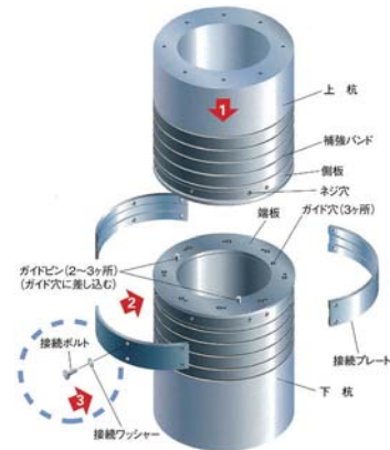
トリプルプレート・ジョイント工法 1)
