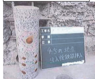
試験施工による モルタル充填状況確認
