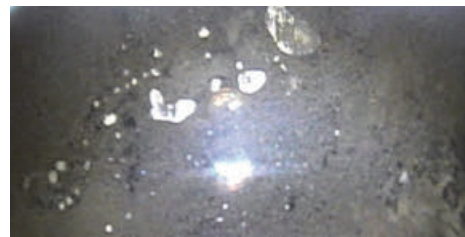
地盤内の気泡の様子
