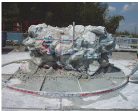
■ 図-3 実物大実験で確認した充填状況 (捨石護岸内の遮蔽壁構造を想定した充填)
