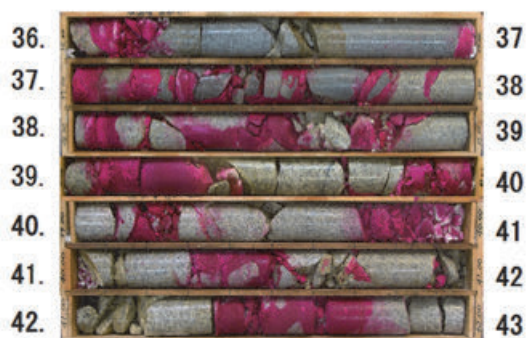
■ 図-6 チェックボーリングで確認した充填状況 (フェノールフタレイン液で着色された充填材)
