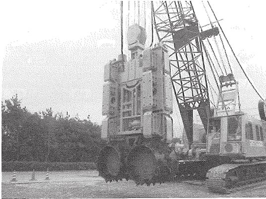
写真-1 地中壁用掘削機
