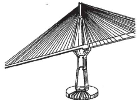
図-3 主塔基礎とオールフリー構造
