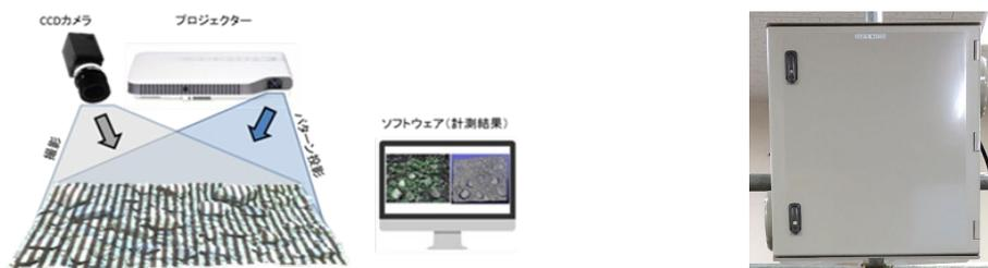
粒径計測システム概要
