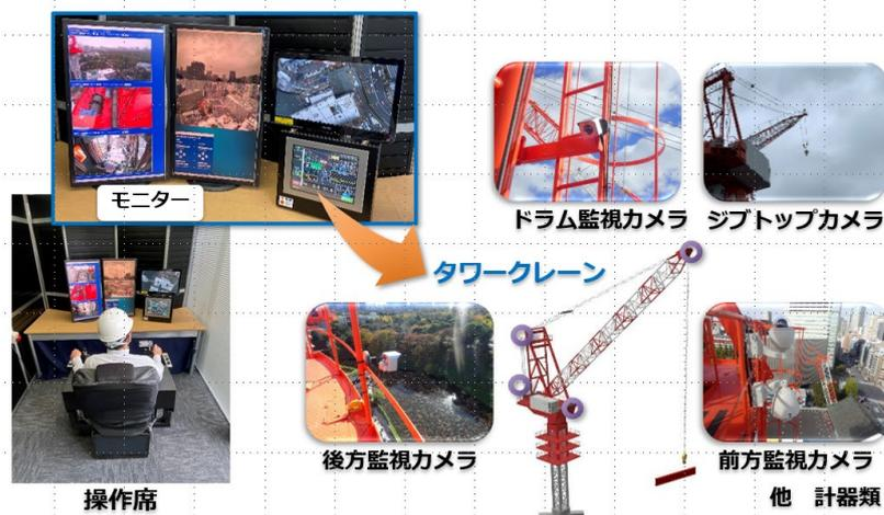
コックピットは、設置場所に応じて省スペースでの設置が可能な「簡易型タイプ」と油圧シリンダーによりタワークレーン本体の揺れを体感しながら操作ができる「専用タイプ」の2タイプから選択をすることができる。
