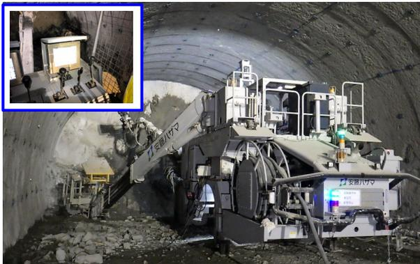
写真-1 遠隔操作中の MG ジャンボ
