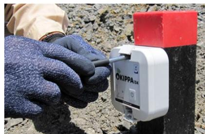
写真－1 センサボックス設置状況
