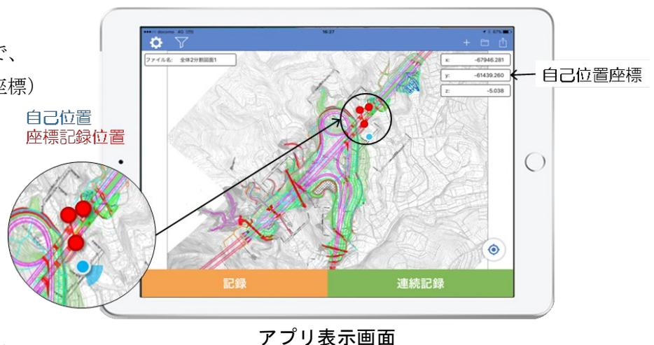
X Y座標の計測精度は端末に搭載されている GPS に依存し、Z座標は気圧の変化量からタブレット端末の移動高低差を算出している。そのため、高さの分かっている基準となる場所で高さのキャリブレーション
