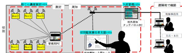
図1 「粉じん濃度測定システム」の全体構成図
