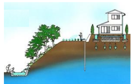
雨水の地下浸透を行い、湧水を保全 13) (雨水貯留・浸透)
