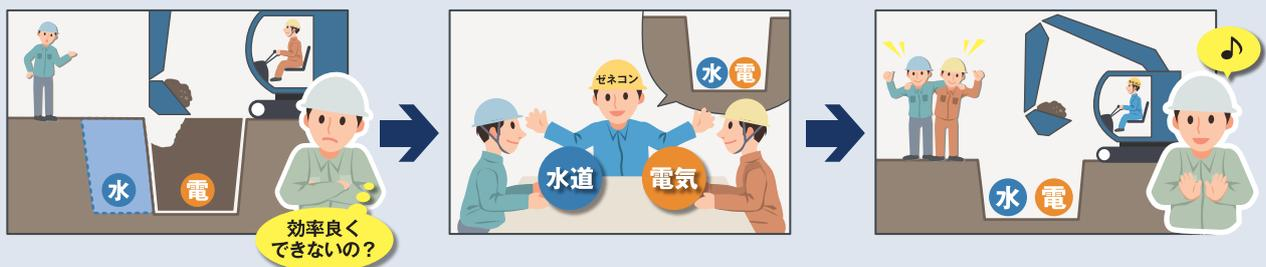
例えば給排水配管と電気配管を一度の掘削で埋設し、工期・コストの無駄を省きます。また足場の組立前に埋設することで、竣工時の外構工事を円滑に進めます。
