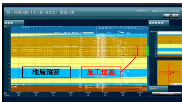
図-2 縦断面図による施工位置の表示
