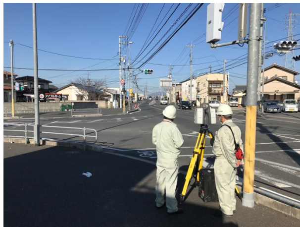
写真－1 3次元計測状況
