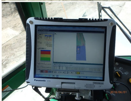
写真.3 GNSSローラー・転圧管理システム
