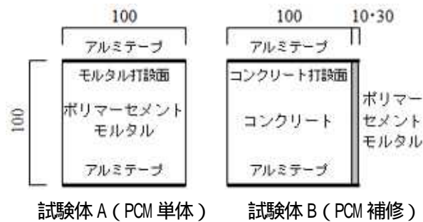
図 - 3.1.1 試験体形状・寸法 [ 単位:mm ]
