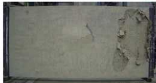
写真3 No.6(PCM20mm, ワイヤー)実験後の状況
