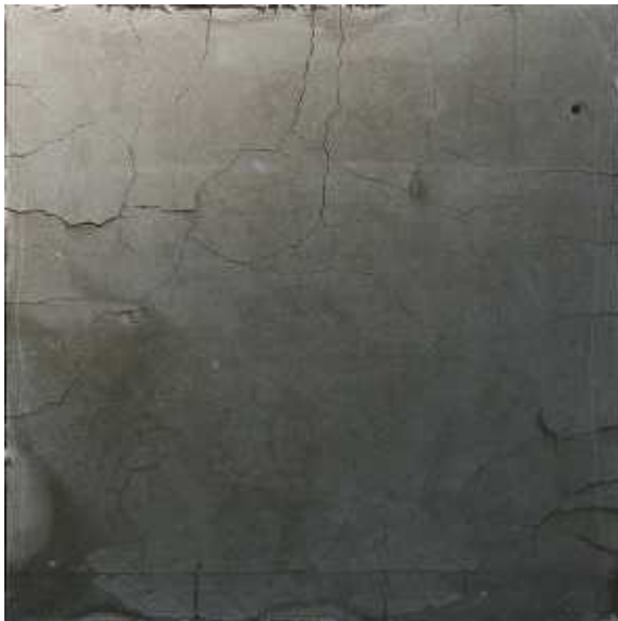
写真 - 3.2.3 耐火試験後の状況(No.1)[P1] 写真 - 3.2.4 耐火試験後の状況(No.2)[P4]
