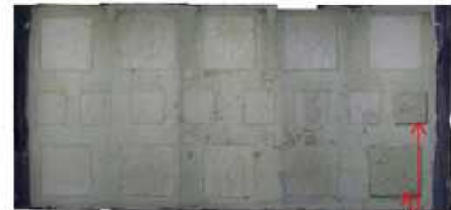
写真2 No.2(パッチ補修)実験後の状況 剥落
