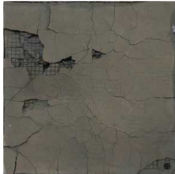
写真 - 3.2.3 耐火試験後の状況(No.1)[P1] 写真 - 3.2.4 耐火試験後の状況(No.2)[P4]
