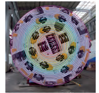
③ リアサポート拡張、グリッパー収縮 ④ グリッパー盛替え、①~④の繰り返し カッターヘッド回転による各カッターの軌跡
