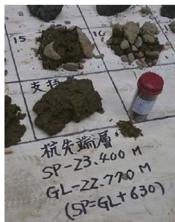
写真 5.2-4 土質標本（サンプル）との照合作業（掘削完了・支持層確認）
