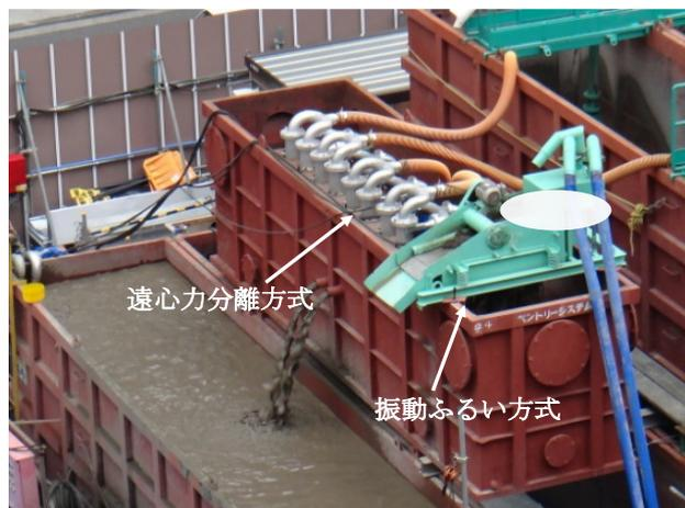
写真 5.2-6 砂分除去装置
