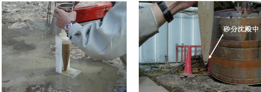
写真 5.2-5 砂分率の測定
