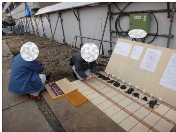
写真 5.2-3 土質標本（サンプル）との照合作業（試験杭時、1m ピッチ）
