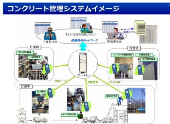
図 2 S-Worker コンクリート管理システム
