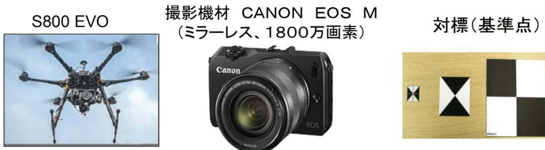
図一 1 UAV 使用機器および基準点对標
