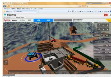
図-3 Virtual Constructionによるクレーン施工計画
