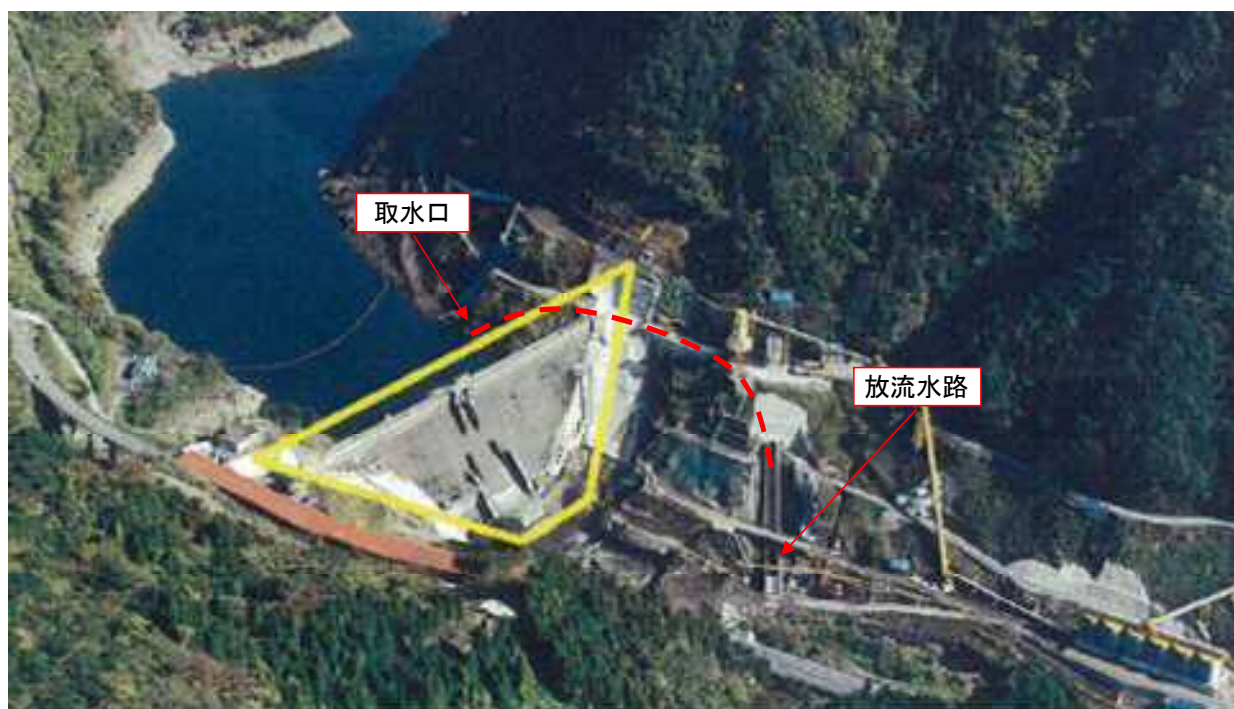
萱瀬ダム取水口工事の計画概要図
