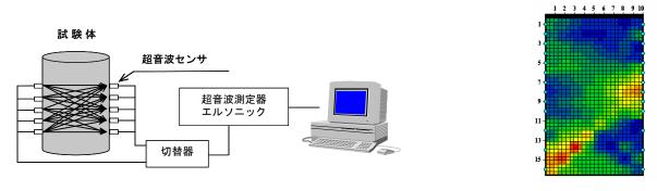
図-2.2.25 超音波トモグラフィー法による品質評価の事例 14)
