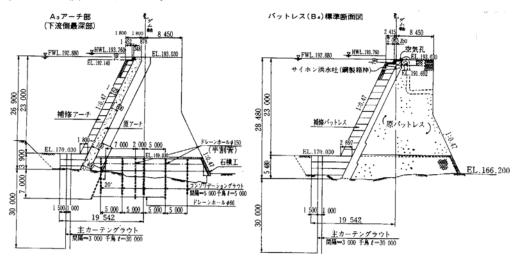
図-2.2.11 補修部の標準断面 12)
