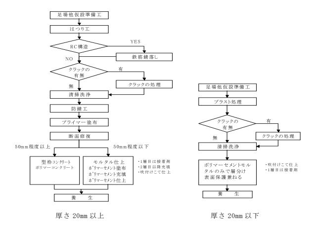
図-2.2.3 漁川発電所堰堤の表面補修フロー
