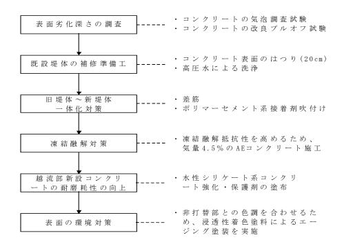
図-2.2.4 幌満第三ダムの断面修復フロー (厚さ 20cm 程度)
