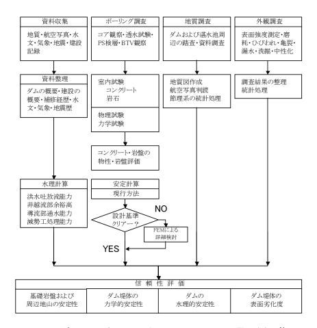
図-2.2.1 ダムの調査項目と処理フロー (関西電力㈱) 1)
