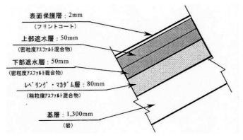
図-2.2.16 高野山ダム遮水壁断面概要図 13)
