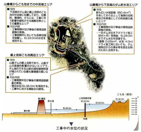
図-2.3.5 山倉ダムの仮設備による水位状況の概念図4)
