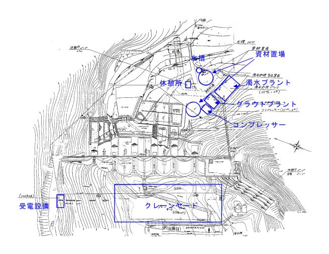
図-2.2.15 豊稔池ダム補修工事 仮設備平面図 7)
