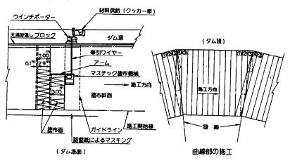
図-2.2.6 アスファルトマスチック施工機械 (沼原ダム補修工事) 5)
