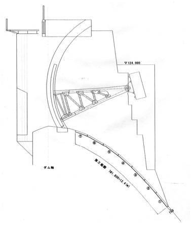
図-2.2.7 山須原ダム堤体表面の補修箇所 (左岸側の一部) 15)
