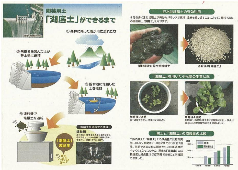
図-1.6.18 湖底土ができるまでの概要図<sup>8)</sup>
