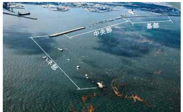
被災した北防波堤。6月には災害査定を終え、7月中旬には港内の静穏度を保つため、消波ブロックによる築堤作業が始まった。災害査定はどこの被災港湾よりも早期に行われた。(提供:東北地方整備局八戸港湾・空港整備事務所)
