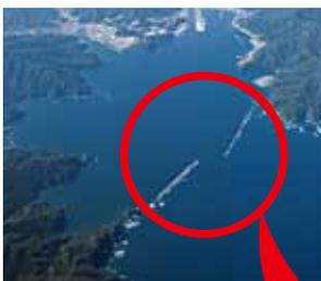
釜石港の湾口防波堤。津波高を4割低減し、陸地への到達時間を6分遅らせた。
