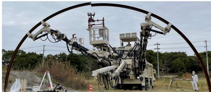
写真 10 微調整機能付きエレクター搭載型吹付けロボット
