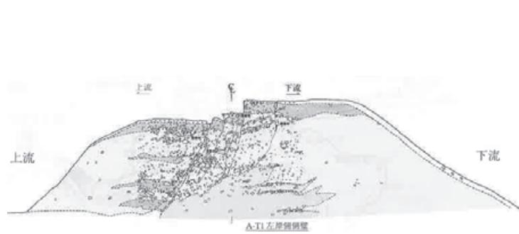
図-2 天端トレーニング側面のスケッチ
