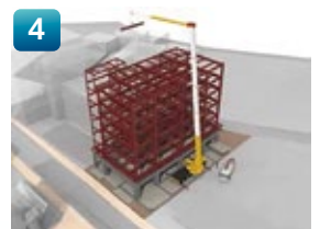
施工計画ステップ図の例 BIMモデル活用による施工計画ステップ図を使用し 複雑な施工手順をアニメーション化 ※2
