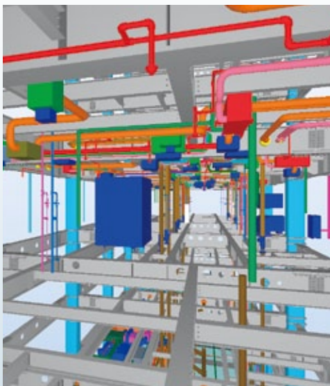
会社関係者間でのデータを統合し 建築・設備の干渉チェック ※3
