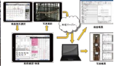
スマートデバイスを活用した配筋検査業務・写真管理の効率化 ※6
