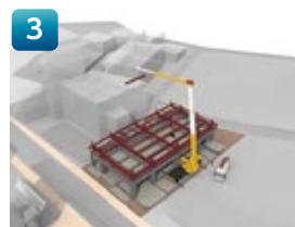
施工計画ステップ図の例 BIMモデル活用による施工計画ステップ図を使用し 複雑な施工手順をアニメーション化 ※2
