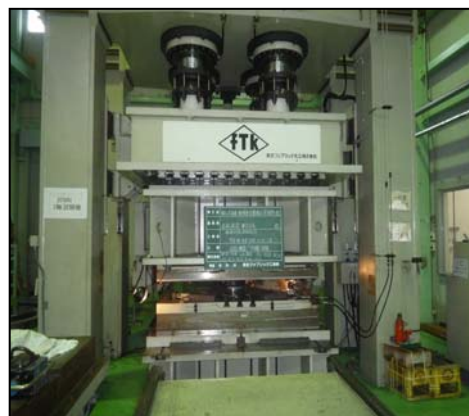
写真-4 免震装置性能試験状況
