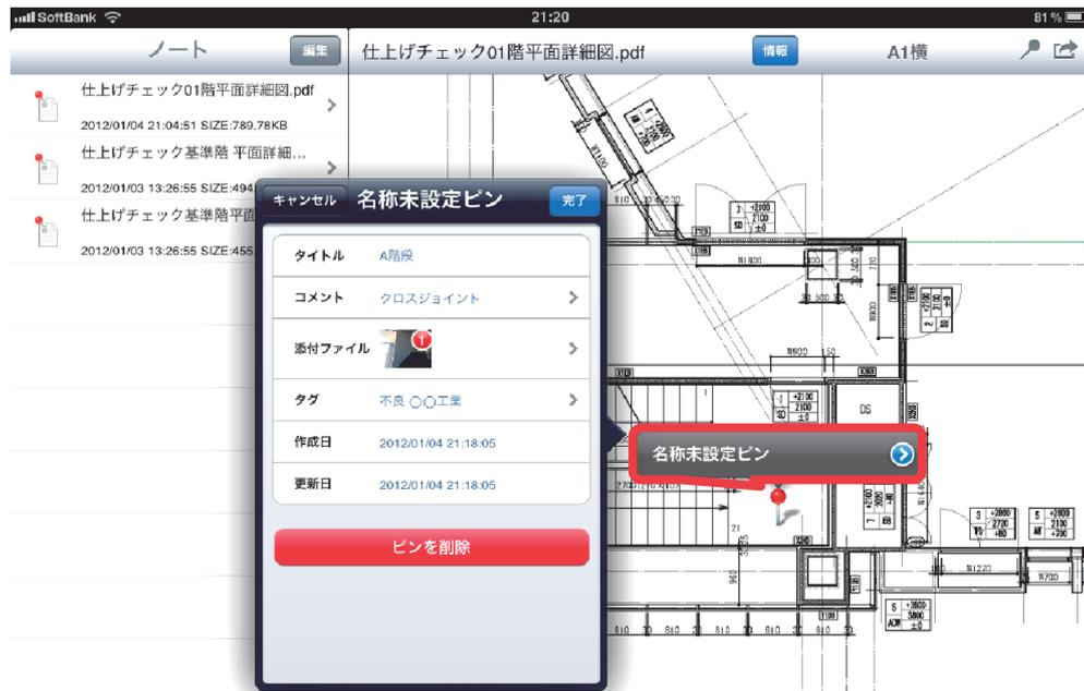
図-4 図面上へのピンドロップ
