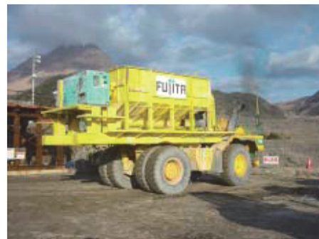
写真-4 高流動コンクリート運搬状況
