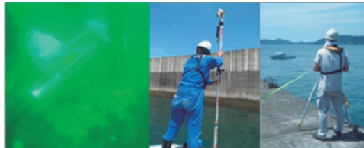
写真-1 水中スタッフと水中水準測量器による計測状況
