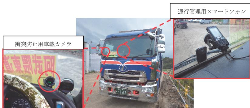
図-5 衝突防止支援システム 設置状況
