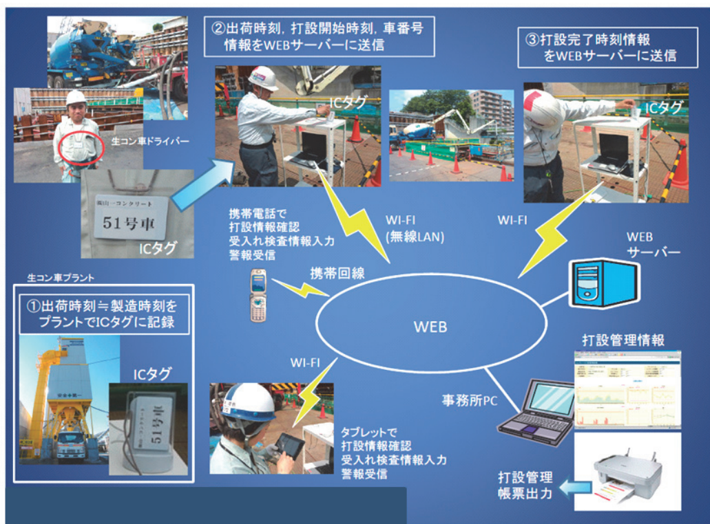
図-3 ICT 打設システム適用例
