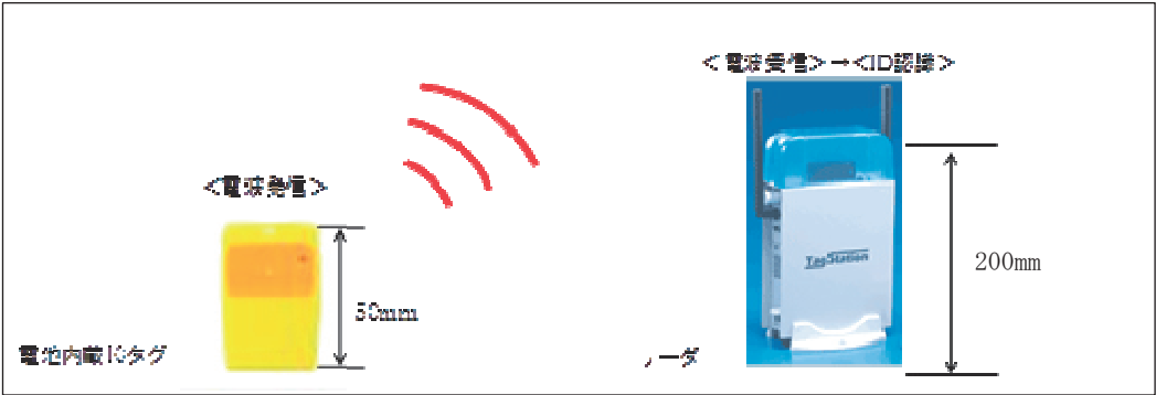
図-2 電池内蔵 IC タグとリーダー
