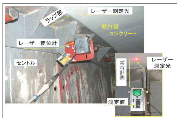
図-5 レーザー変位計による計測状況
