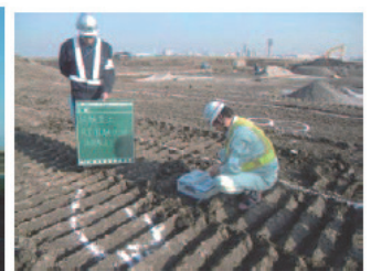
写真-2 RI 法による計測
