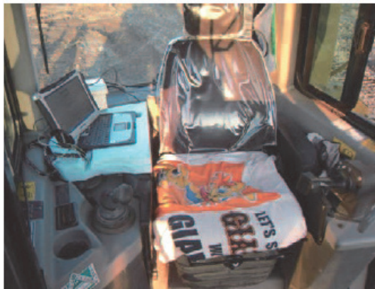
写真-5 重機搭載 PC (運転席左)
