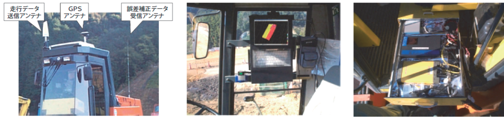
写真-1 GPS受信機を搭載した盛土の転圧重機
