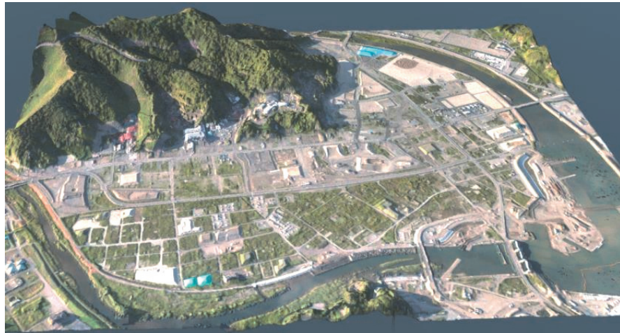
図-3 UAV 出来高測定の3D出力例
