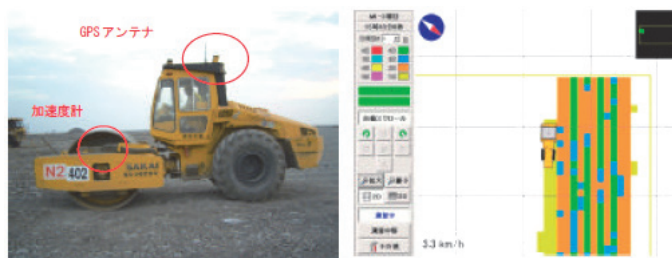
図-4 振動ローラ転圧管理システム
