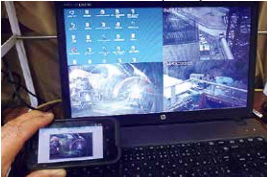
WEBカメラ、スマートフォンによる監視の例
