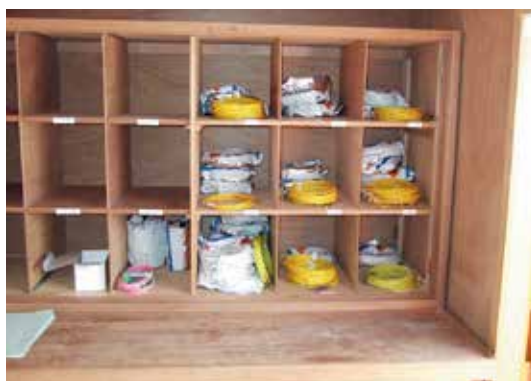
導火管付き雷管の整理棚（取扱所）の例
