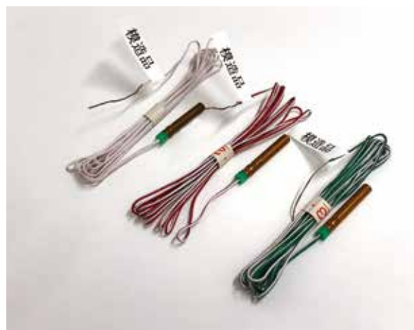
電気雷管（模造品）の例
