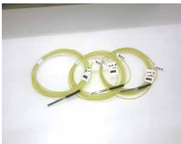
導火管付き雷管（模造品）の例
