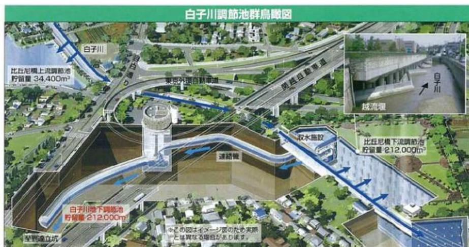
トンネルは、シールド工法によって構築され、そのセグメントには、二次覆工省略型のセグメントが採用されている。
