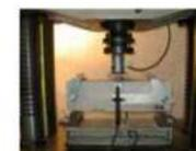
破壊エネルギー試験状況
