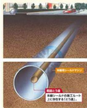
本線トンネル工事と既設トンネルの支障イメージ図
