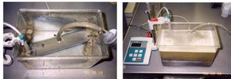
【アクアグラウト (写真左) は分離しないので水が濁らない。エアモルタル (写真右) は分離して水が濁っている】
