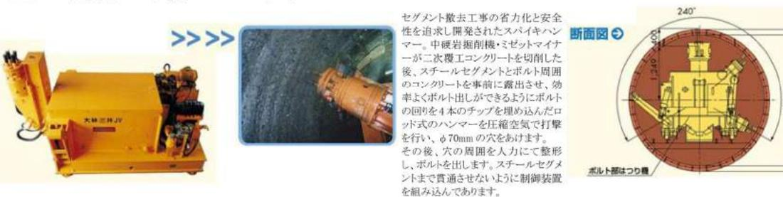
セグメント撤去工事の省力化と安全性を追求し開発されたスパイキハンマー。中硬岩掘削機・ミゼットマイナーが二次覆工コンクリートを切削した後、スチールセグメントとボルト周囲のコンクリートを事前に露出させ、効率よくボルト出しができるようにボルトの回りを4本のチップを埋め込んだロッド式のハンマーを圧縮空気で打撃を行い、φ70mmの穴をあけます。その後、穴の周囲を人力にて整形し、ボルトを出します。スチールセグメントまで貫通させないように制御装置を組み込んであります。
