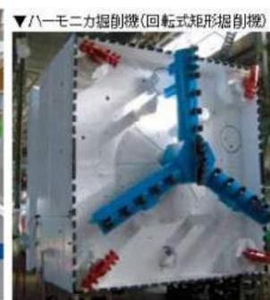
▼ハーモニカ掘削機(回転式矩形掘削機)
