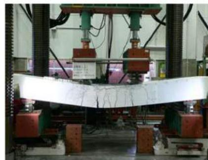
平板実物大曲げ試験状況
