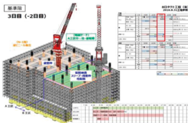
図5 躯体タクト 5D-BIM 検討
