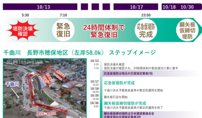
図 2-5 長野市穂保地区の堤防緊急復旧のステップ (提供:北陸地方整備局)
