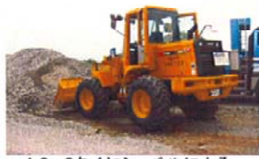
1.3m³タイヤショベルによる 再生砕石積み込み
