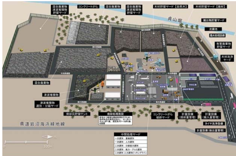
図-1 二次仮置き場の施設配置
